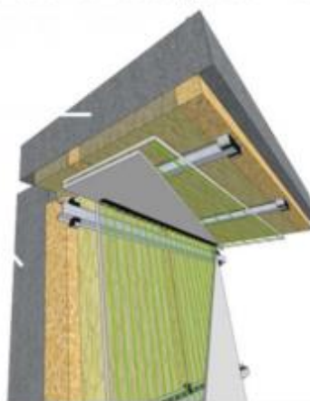
Figur 2. Illustrasjon av lydisolert vegg og himling ved hjelp av gummikobling. Figur er hentet fra https://dreamscreen.no .
