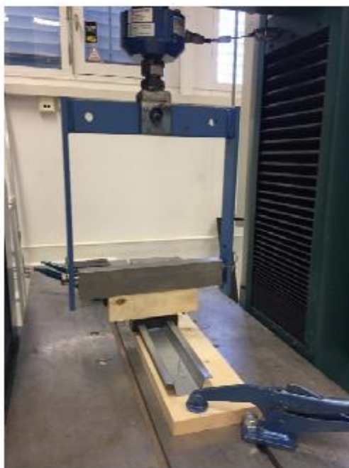
Figur 3. Prøvingsoppsett for takmontering (uttrekk).
